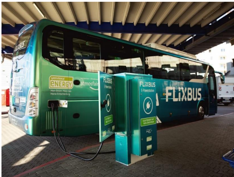
Rysunek 2. Autobus elektryczny sieci FlixBus podczas ładowania
