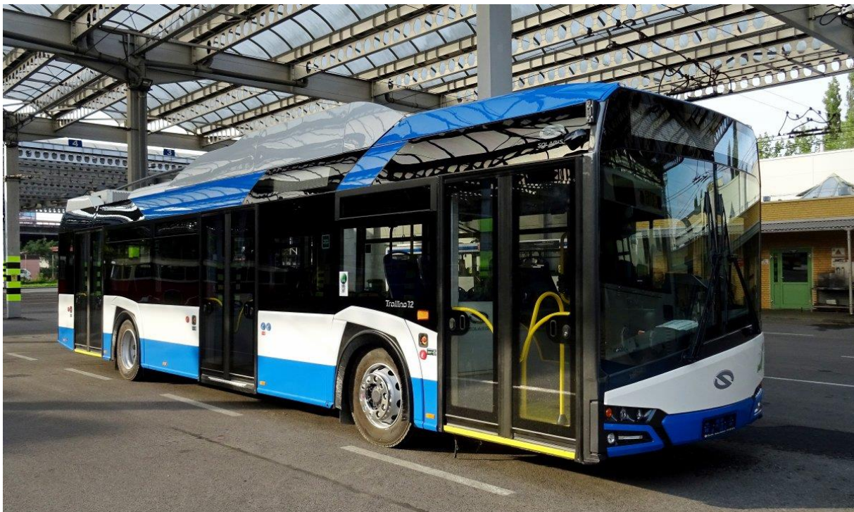
Rysunek 10. Trolejbusy Trollino 12 firmy Solaris z zamontowanymi bateriami umożliwiającymi jazdę poza terenami posiadającymi trakcję trolejbusową – Gdynia (źródło: https://www.gdynia.pl )
