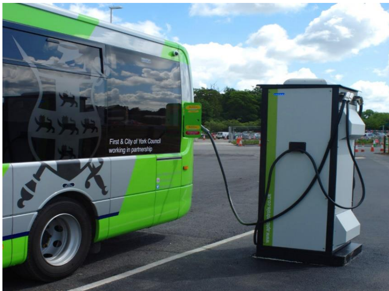
Rysunek 1. Przykład ładowania za pomocą złącza wtykowego – York's Park & Ride w mieście York, w Wielkiej Brytanii
